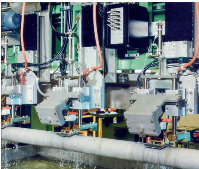
對應鑄鋁坯表面粗糙 配置大型金屬防護裝置避免水柱噴嘴與探頭受損
