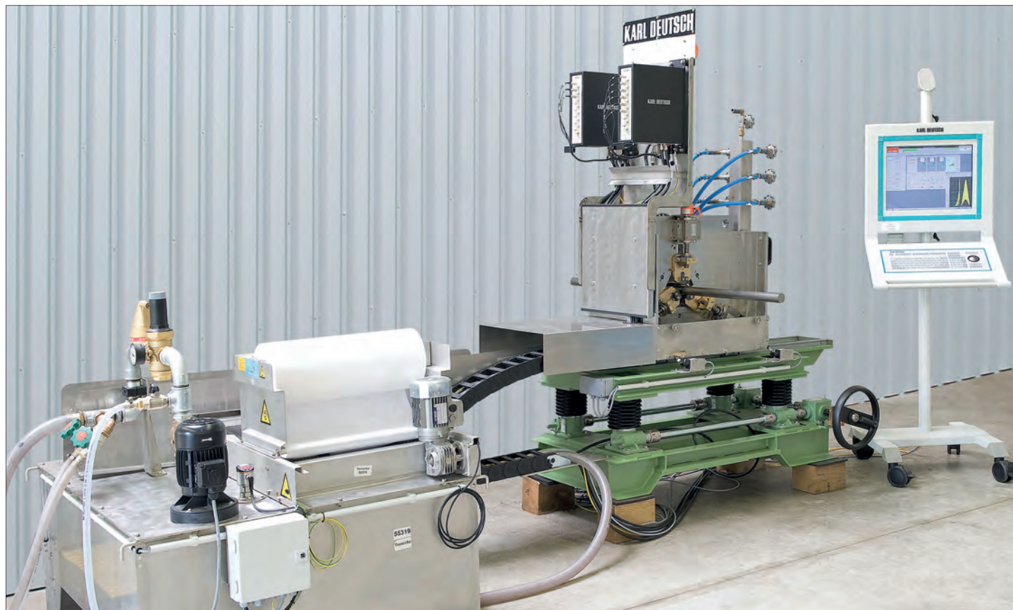
配備水過濾裝置、檢測平台及操作面板的棒材全自動檢測設備
