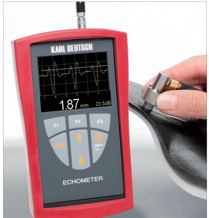
ECHOMETER 1077：對複雜幾何形狀的物體，採 A-Scan 進行超聲厚度測量
