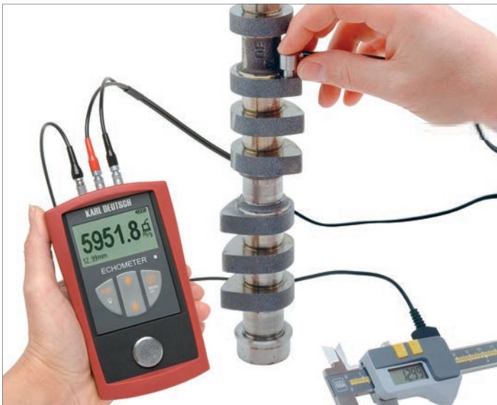
ECHOMETER 1076：凸輪軸上進行聲速測量
