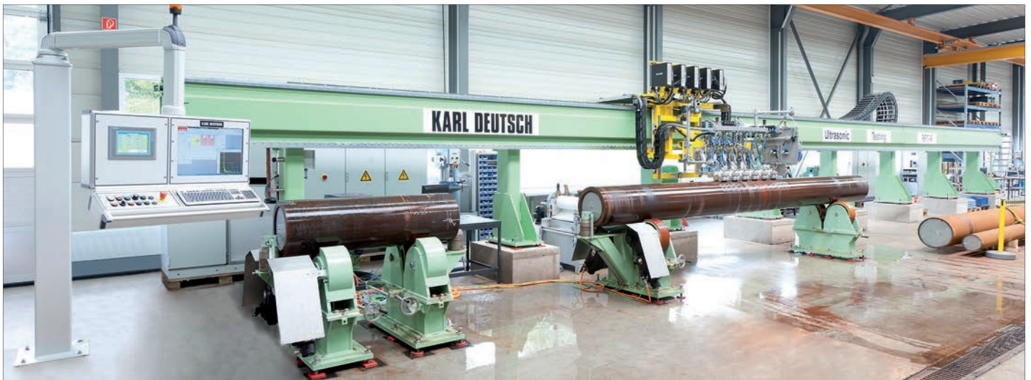
無縫鋼管的超音波自動化檢測系統，配置 6 個探頭架，共 30 個檢測探頭
