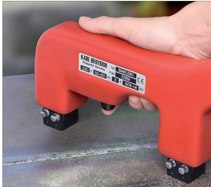
以手持式磁軛檢測焊縫品質 (DEUTROPULS 3446)
